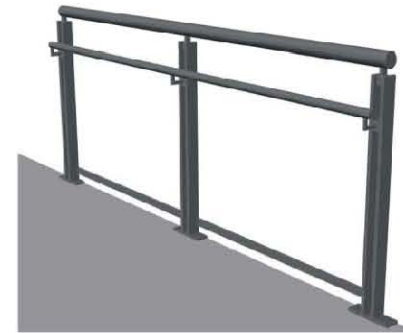
4 L-13 RAMP RAILING - 42' HT. - 3D VIEW SCALE: N.T.S.
